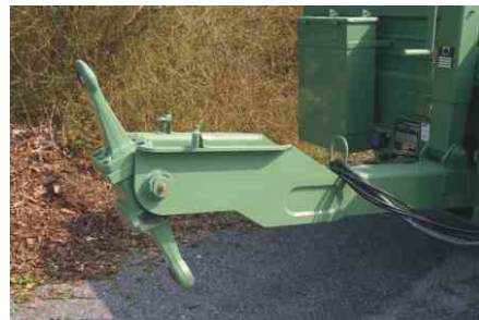
Schwenkkopf mit wahlweise 40mm und 50 mm Zugösen
