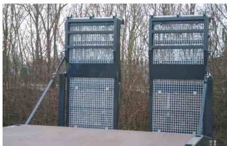
Verbreiterte Rampen, verlängert, klappbar, mit Gitterrost als Belag
