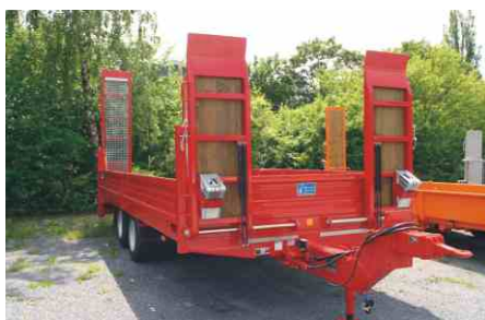
Überfahrrampe mit 3,5to Traglast pro Paar
