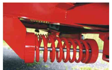
Rampenfederhebework anstelle Gasdruckdämpfer
