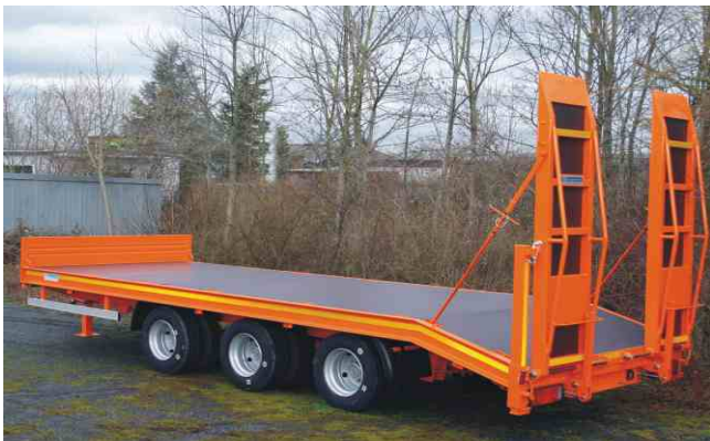
Ges.-Gew. 25000 kg , Bestellnr. 689/25000 Tridem, NL ca. 20000 kg, Lademaß ca. 6200x2450 mm, Ladehöhe unbeladen ca. 1020 mm, zwillingsbereift, Zubehör: fehlende Seitenbordwände
