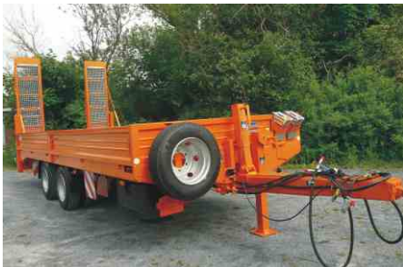
Ersatzrad und Ersatzradhalter an der Stirnwand angebracht
