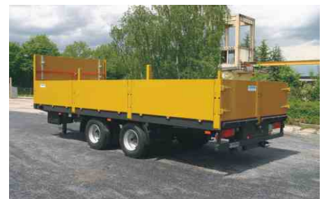
Sonderfahrzeug: erhöhte Alu-Seitenbordwände, Flügeltür, erhöhte Stirnwand
