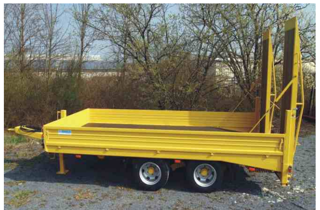
Ges.-Gew. 10500 kg , Bestellnr. 663/10500, NL ca. 7800 kg, Lademaß ca. 5000x2450 mm, Ladehöhe unbeladen ca. 880 mm, Zubehör: steckbare Eckpfosten hinten
