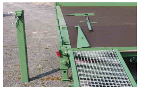
Eckpfosten abnehmbar - für maximale Auffahrbreite
