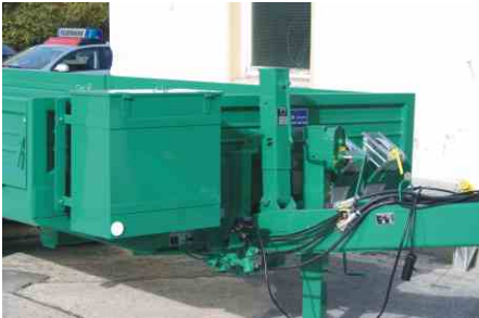
Stahlblechkiste an der Stirnwand montiert
