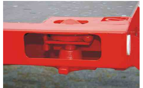
Containerverriegelungen im Boden eingearbeitet
