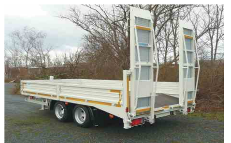
Verzinkte Gitterroste anstelle Holzbelag in den Rampen
