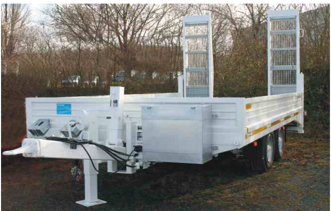
Ges.-Gew. 11900 kg , Bestellnr. 664/11900, NL ca. 9200 kg, Lademaß ca. 5000x2450 mm, Ladehöhe unbeladen ca. 880 mm, Zubehör: Rampenbelag Gitterrost, Werkzeugkiste
