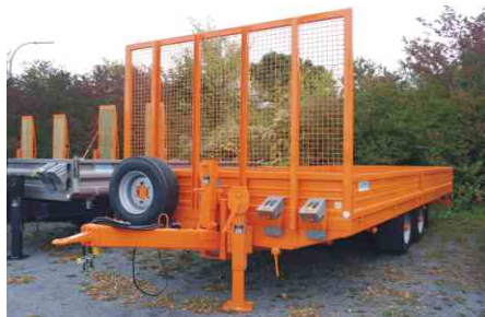
Stirnwanderhöhung aus Welldraht
