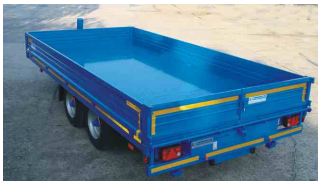
Ges.-Gew. 10500 kg , Bestellnr. 694/10500, NL ca. 8000 kg, Lademaß ca. 5000x2450 mm, Ladehöhe unbeladen ca. 880 mm, Zubehör: Tränenblechboden, Halter für Rungen im Boden eingearbeitet, Rungen an der Stirnwand arretierbar
