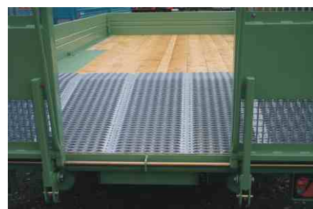
Gleitschutzroste 2 mm stark
