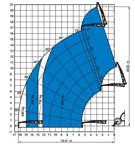
Mit 3 to Hydraulikwinde mit Abstützungen
