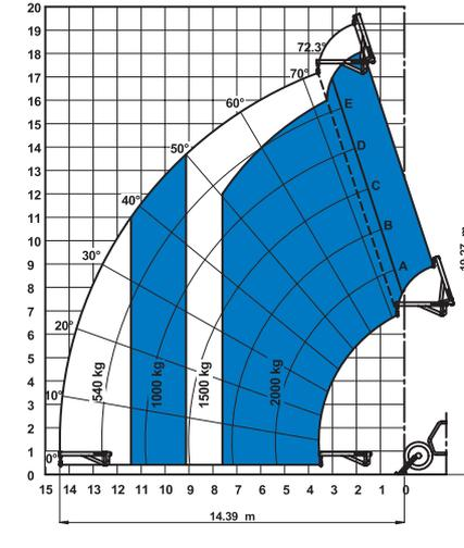
Mit 4 m mechan./hydraul. Montagearm mit Abstützungen
